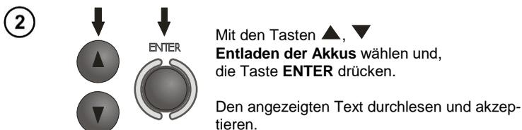
Das Entladen, das in Abhängigkeit vom Ladezustand des Pakets bis zu 10 Stunden dauert, wird mit der Aufschrift: **Verlauf des Entladeprozesses** signalisiert.
