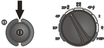
Messgerät einschalten. Den Drehschalter für die Funktionswahl auf die Position **3p** stellen.
